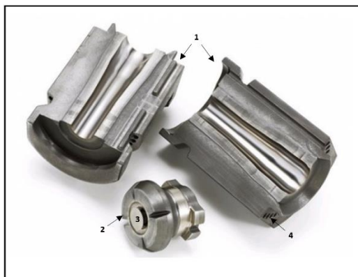
Figura 2.11. Molde de começar ou contra-molde [21]; 1 – Duas metades (macho e fêmea); 2 – Tampão; 3 – Válvula do tampão; 4 – Furos para passagem do ar de arrefecimento.
