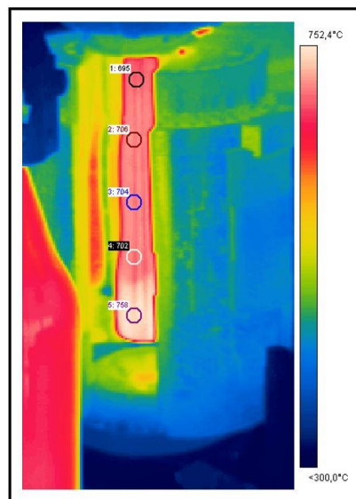
Figura 3.3. Termografia por infravermelhos ao esboço de vidro.
