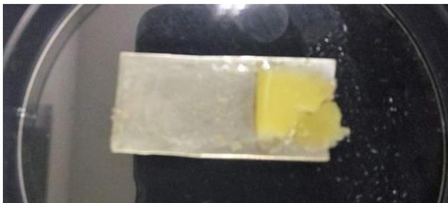
*Figura 32 - Polimerização em substratos de prata, com a fácil remoção do ionogel.*
