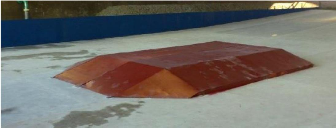
**Figura 3.1.** Vista em perspectiva do recife artificial, instalado no tanque de ondas do INPH. (Aguiar et al., 2014).
