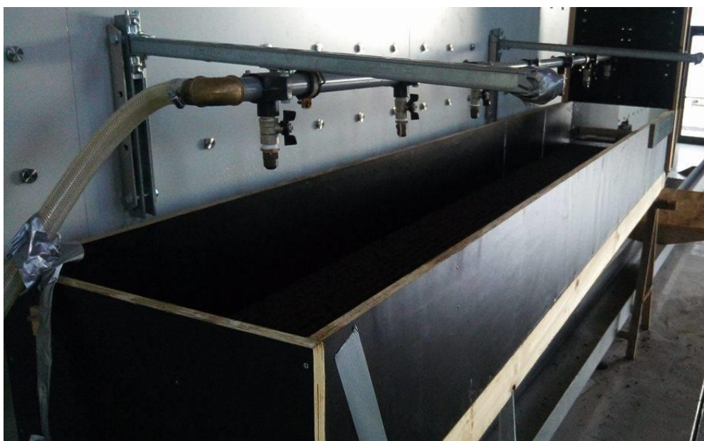
Figura3.10 - Provede de ensaio para drenagem horizontal
