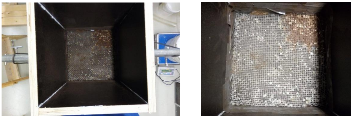
Figura 3.8- Provetes com amostras de ICB em sistema completo
