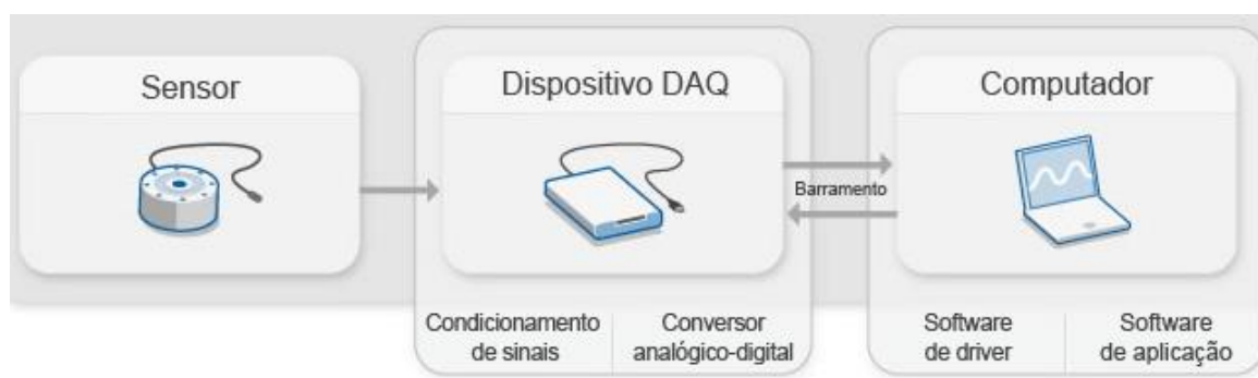
Figura 2.1 - Componentes de um sistema de aquisição de dados [National Instruments®]
