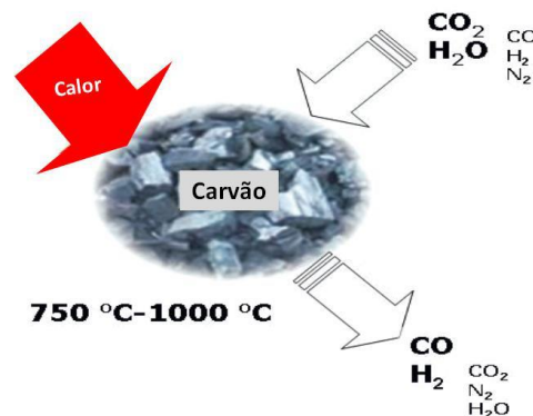
Figura a) 6 - esquema do processo de gaseificação (Barrio, 2002 apud Pedrosa 2012)
