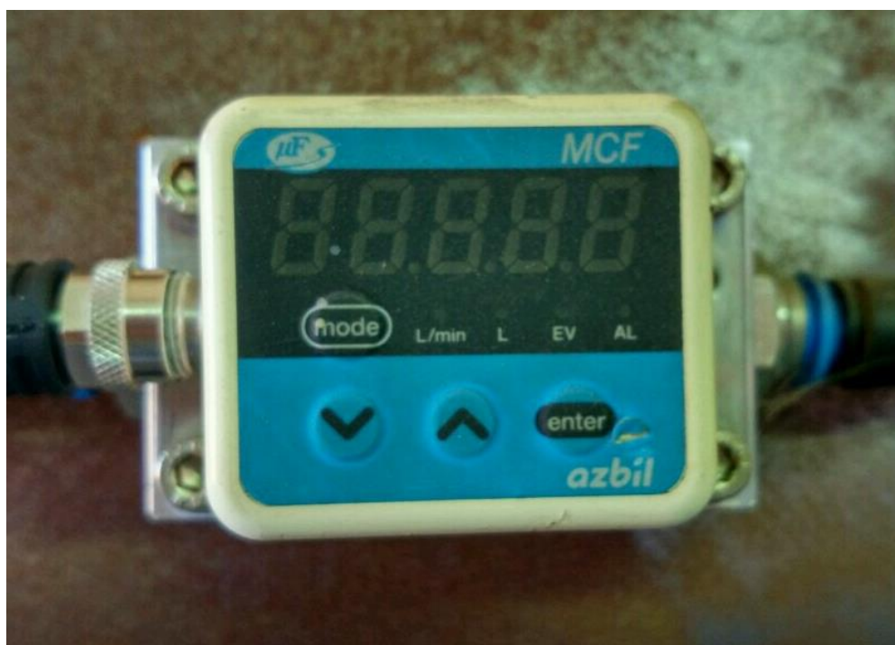
Figura 3.5 – Caudalímetro de massa térmico “MCF0150ARND010000”
