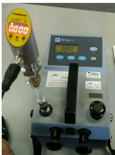
Figura 5.1 - Calibrador de pressão (Druck – DPI 603)
