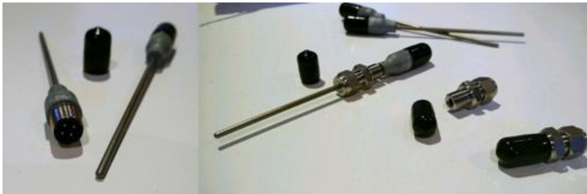
Figura 3.3 – Sonda Pt100 “TP-203A-CF-H1141-L100” utilizadas para a medição da temperatura
