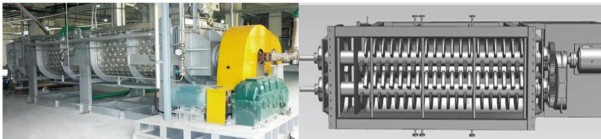
Figura 4.9 - Secador de discos rotativos (Dryingmachineschina, 2017).
