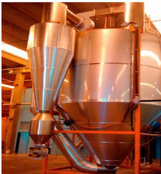
Figura 4.7 - Secador de atomização (Sprayprocess, 2017).
