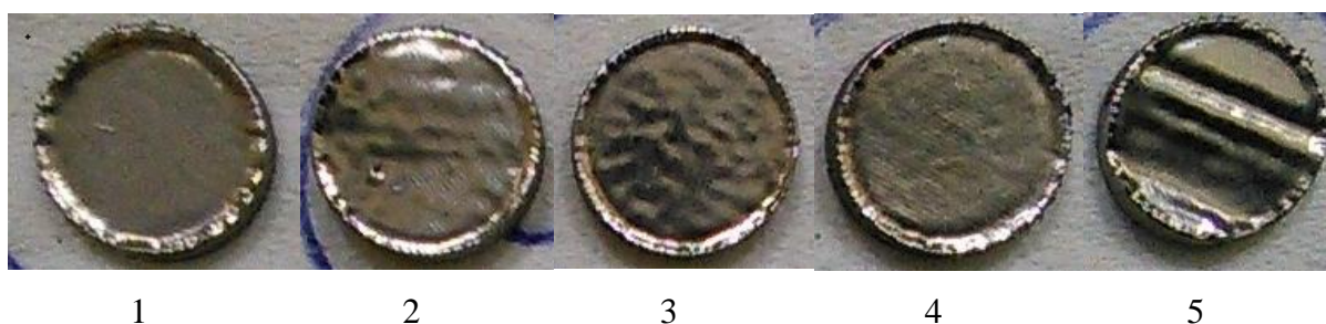
Figura 4.8. Após SLM de pós de H13 revestidos com H13
