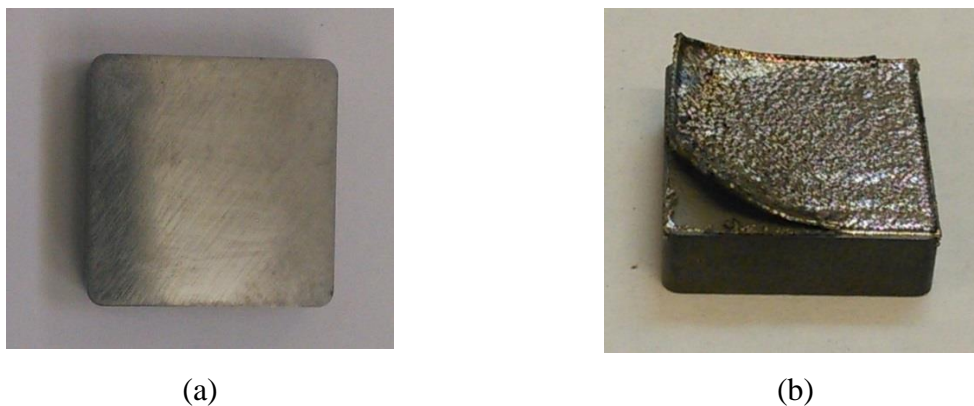
Figura 4.13. Superfície da base de WC revestida durante 6h com aço H13 (a); Tentativa de produção de pó de aço H13 sobre a base de WC revestida com H13 (b).
