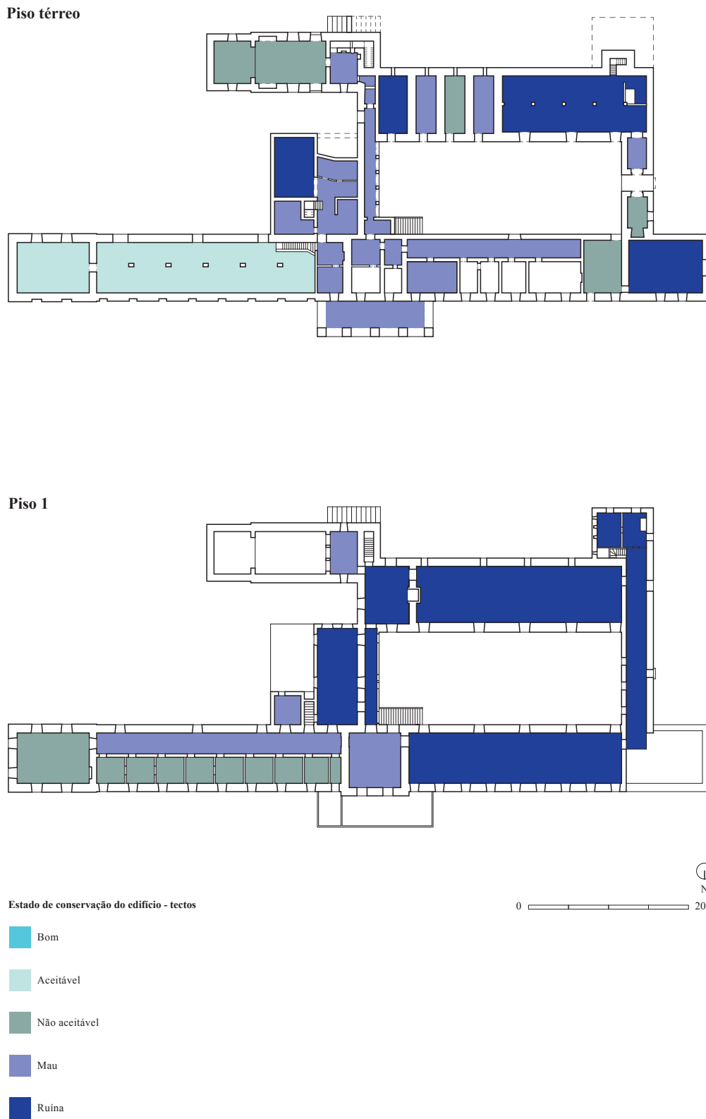
Figura 3.21 – Mapa do estado de conservação do edifício - tectos
