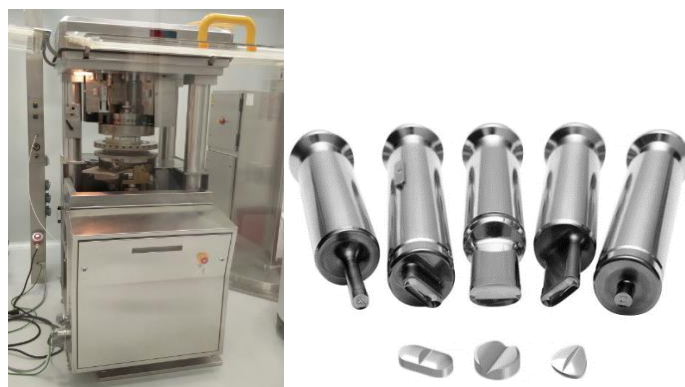
Figura 5.6. Fette 1200i instalada na Farmalabor (esquerda); possibilidades de punções resultando comprimidos com diferentes formas e marcações (direita [20]).
