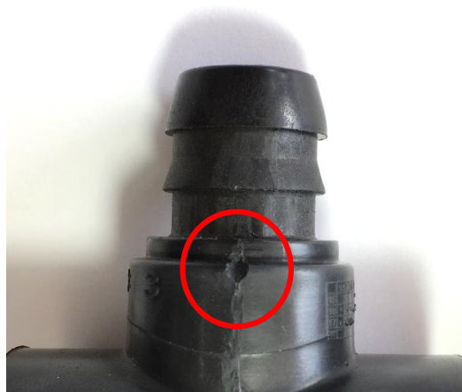
Figura 9 - Defeito a ser rejeitado
