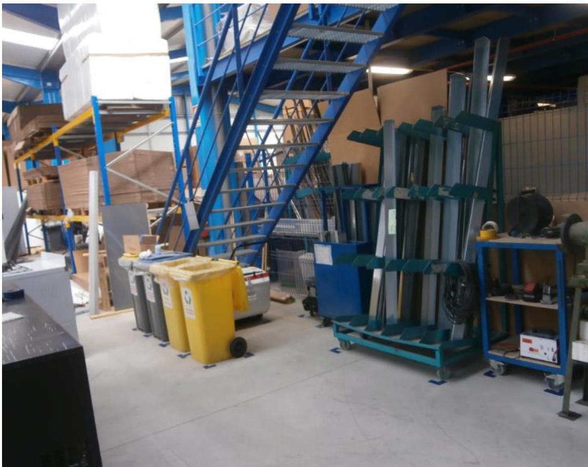
**Figura 29- aplicação da ferramenta 5's.**
