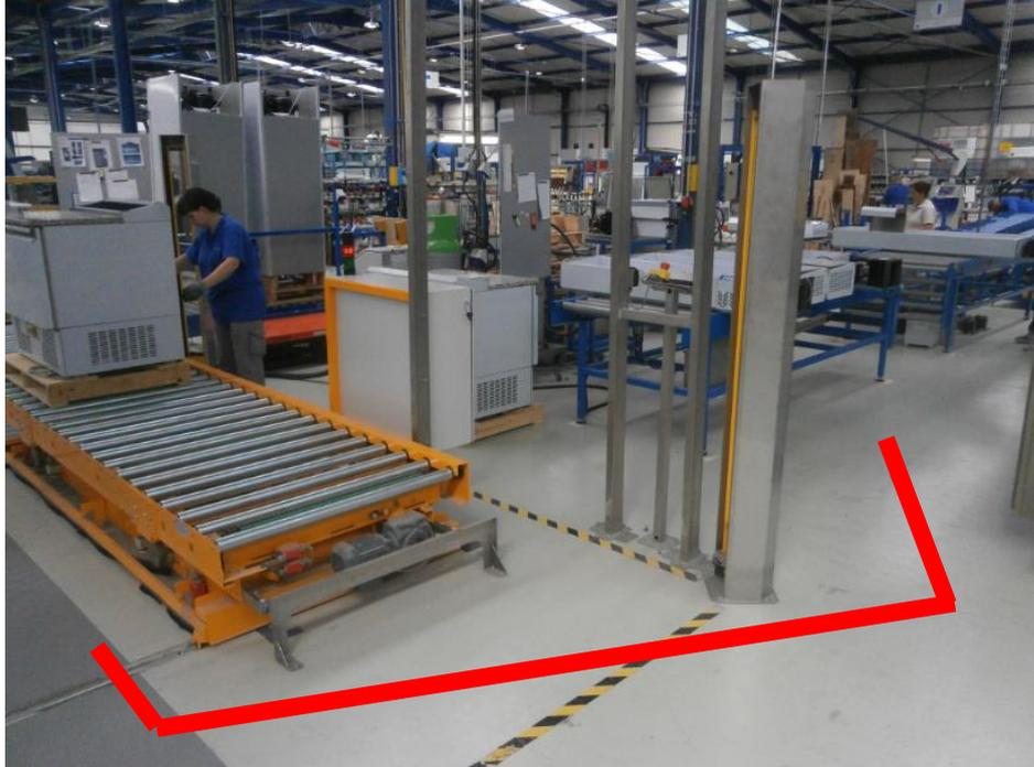
**Figura 9- deslocação necessária do operador para colocar o produto na linha da qualidade.**
