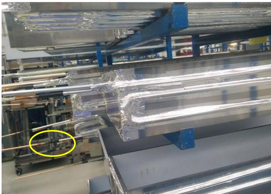
**Figura 17- soldadura do aumento de cobre na serpentina.**
