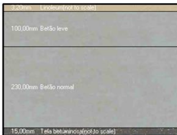
Figura 4.10 - Seção transversal do rés-do-chão original
