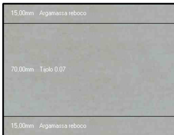
Figura 4.6 - Seção transversal das paredes interiores
