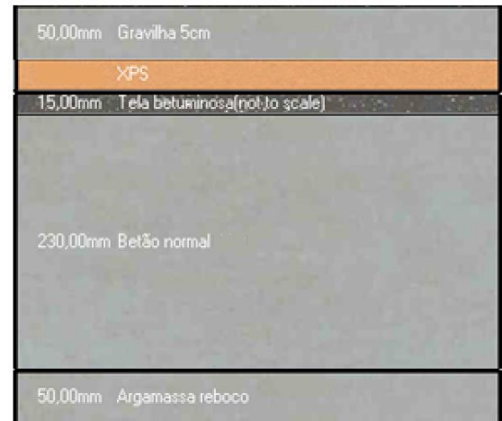
Figura 4.13 - Seção transversal da cobertura invertida pós-reabilitação
