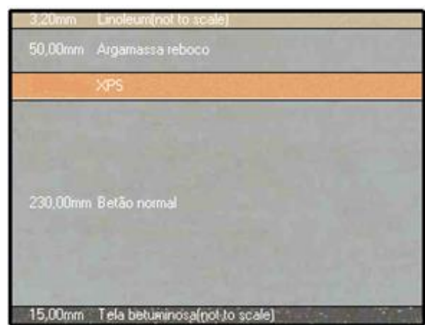
Figura 4.11 - Seção transversal do rés-do-chão pós-reabilitação
