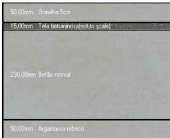
Figura 4.12 - Seção transversal da cobertura numa fase inicial
