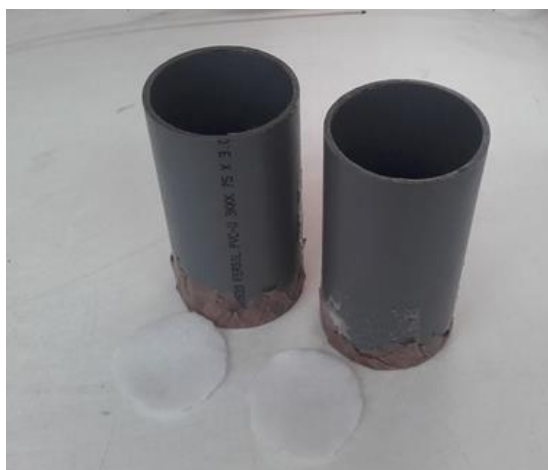
Figura 4.5 - Moldes em PVC revestidos com fita adesiva e respectivo geotêxtil a colocar na base
