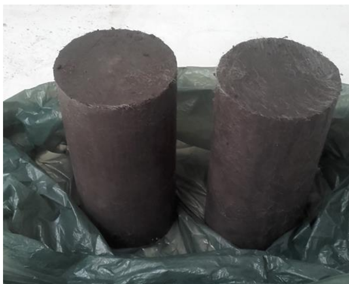
Figura 4.10 - Apresentação final dos provetes, após desmoldagem e correção dos topos
