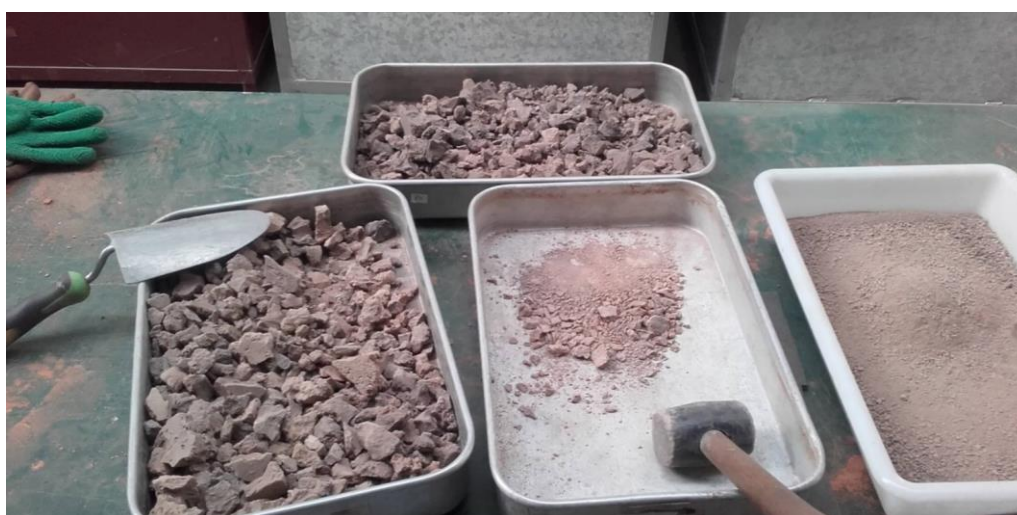
Figura 4.4 – Modo de preparação do solo E (solo mole sem matéria orgânica)
