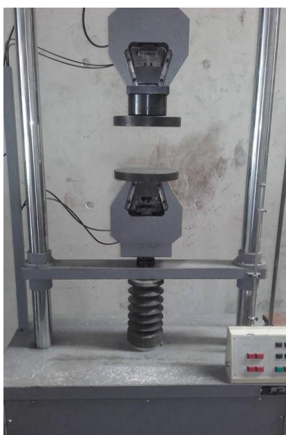
Figura 4.13 – Prensa Servosis (célula de carga com capacidade de 200 kN e precisão \pm 0,1 kN)
