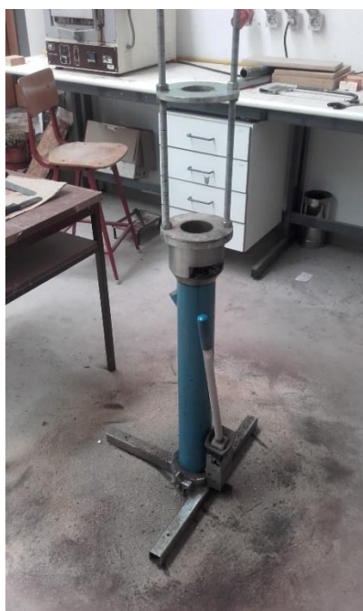
Figura 4.9 - Extrator hidráulico utilizado para a desmoldagem dos provetes
