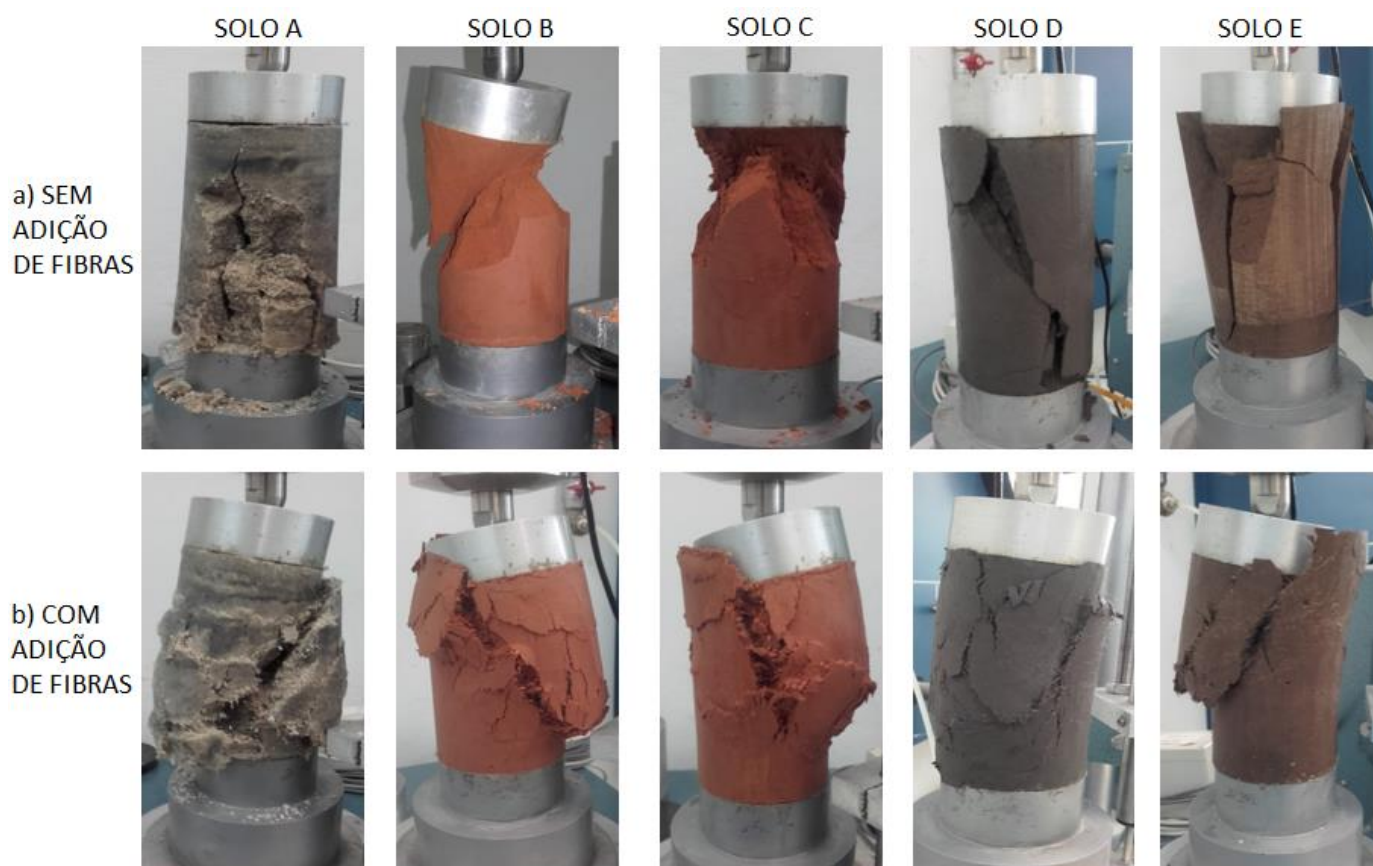
Figura 5.6 – Modo de rotura para os provetes dos diferentes solos: a) sem adição de fibras, b) com adição de fibras ( 10 \text{ kg/m}^3 )
