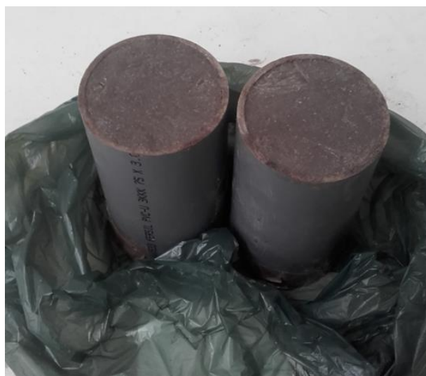
Figura 4.8 - Apresentação final dos provetes de solo natural dentro dos moldes de PVC antes de serem fechados dentro de um saco de plástico e entrar na câmara termohigrométrica
