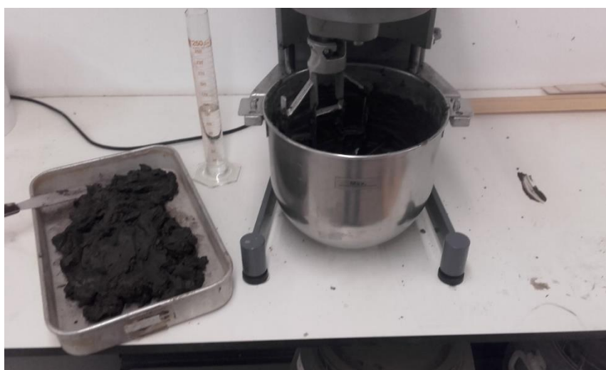
Figura 4.2 – Modo de preparação do solo D (solo mole)
