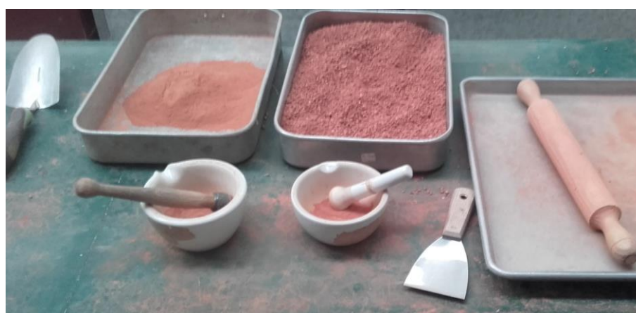
Figura 4.3 – Modo de preparação solo B (silte arenoso)
