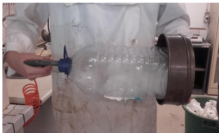
Figura 4.6 – Separação das fibras com auxílio de uma pistola de ar comprimido
