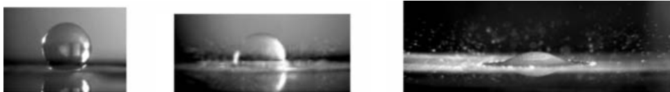
Figura 1.6: Representação do fenómeno de Prompt Splash , adaptado de Yarin (2006)
