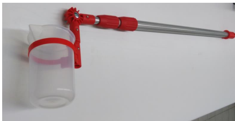
Figura 14 – Copo de recolha acoplado a uma haste telescópica.
