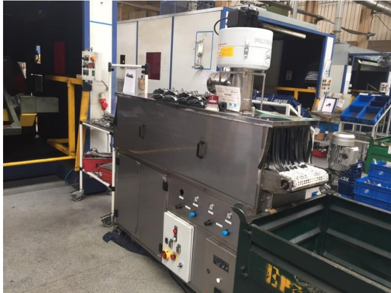
Figura 33 - Túnel de pulverização
