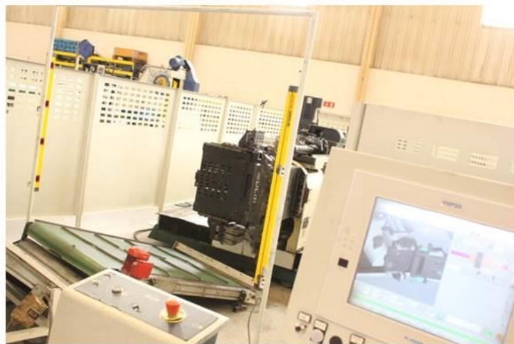
Figura 17 - Máquina de dobrar tubos e arames
