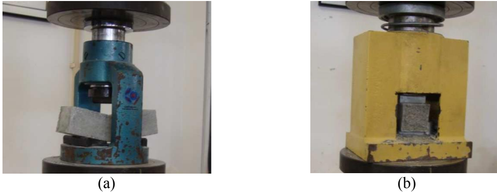
Figura 4.14 – (a) Ensaio de flexão; (b) Ensaio de compressão.
