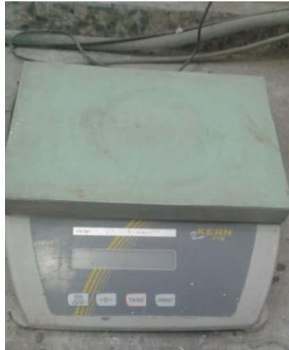
Figura 4.5 – Balança onde foram pesados os materiais (exceto superplastificante) com precisão de 1 grama.
