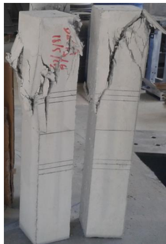
Figura 4.18 – Maior desagregação do material após o ensaio (provete com 1% de fibras).
