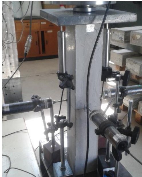
Figura 4.16 – Disposição dos LVDT's para medição dos deslocamentos.
