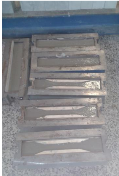
Figura 4.7 – Moldes de provetes betonados, para ensaios de determinação da lei constitutiva em zona de compressão e de tração.
