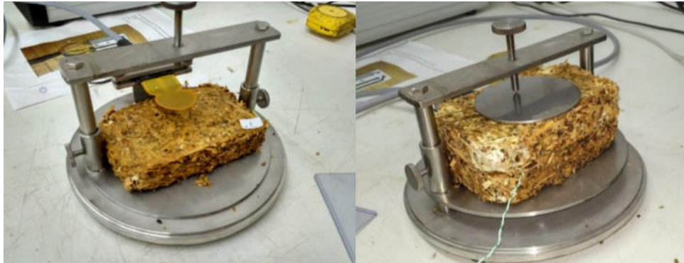
Figura 5.8. Montagem dos provetes para a medição da condutividade térmica.
