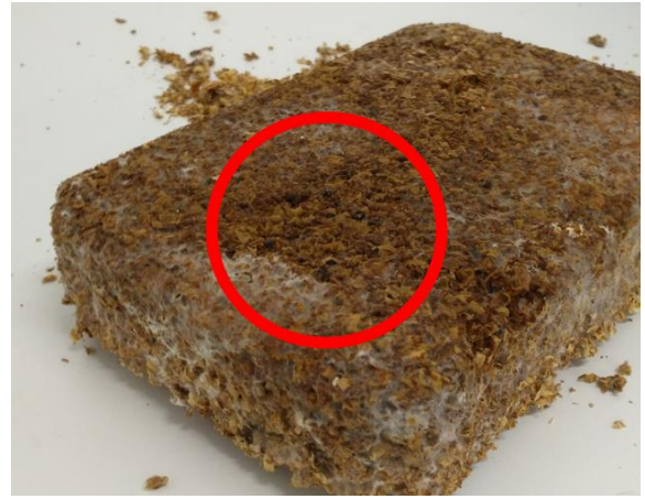
Figura 4.15. Amostra que apresenta problemas de crescimento do micélio e falta de propagação concentrada na zona onde esteve em contacto com fundo da caixa.
