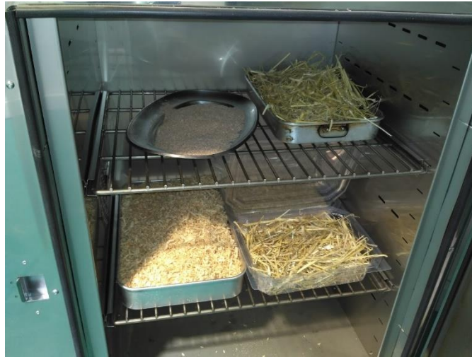
Figura 4.12. Processo de esterilização utilizando um forno de secagem.
