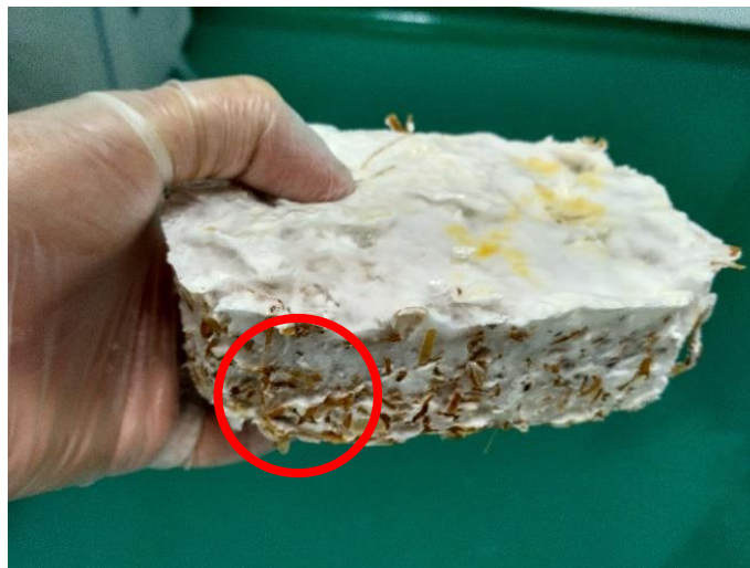
Figura 4.16. Amostra com um bom desenvolvimento do micélio, mas com falta de propagação concentrada.
