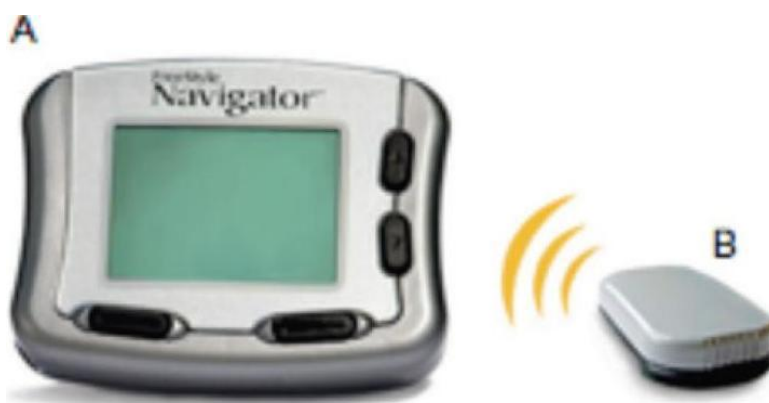
Figura 34 – Freestyle Navigator® . A- Ecrã. B- Sensor. Figura retirada de Blevins et al (2010).
