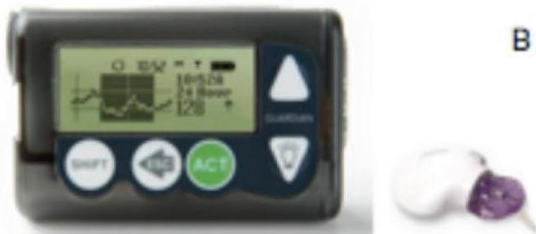
Figura 33 – Guardian® REAL-Time com novo transmissor - Minilink™. Figura retirada de Blevins et al (2010).
