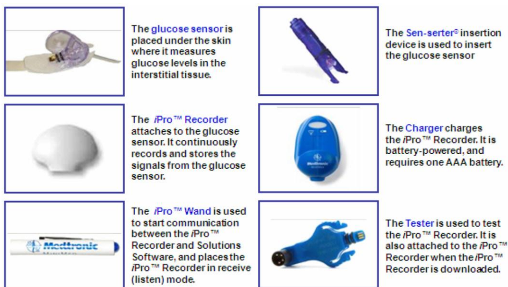
Figura 16 – Componentes do Sistema iPro ®. Figura retirada de Blevins (2010).
