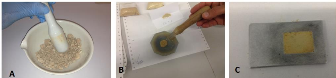
Figura III.5. Ilustração da fase inicial de preparação das amostras para análise de difração de RX da mineralogia total; A. Desintegração física da amostra nos almofarizes; B. Moagem da amostra; C. Amostra acomodada no porta amostra.
