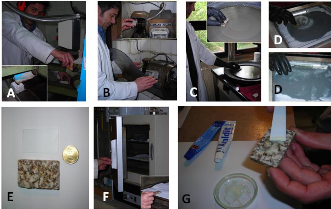
Figura III.9. Fase inicial da criação de lâminas delgadas (retirado de Silva et al., 2007) : A. Corte de amostra na serra de corte de rochas; B. Ajuste da dimensão da amostra; C. Alisamento das faces no tabuleiro; D. Despolimento de faces de vidro; E. Secagem da amostra alisada e despolida; F. Secagem da amostra na estufa; G. Colagem da esquírola a lâmina de vidro.
