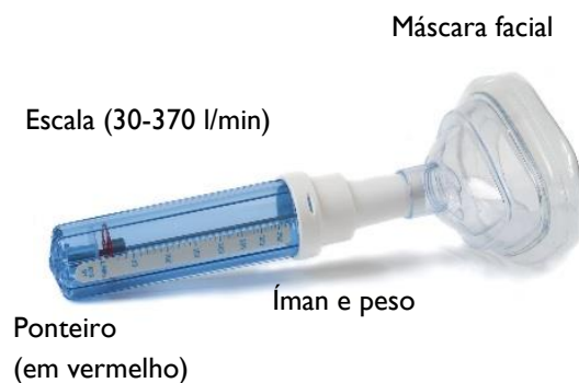
Figura 1 – Medidor do Pico de Fluxo Nasal Inspiratório (Clement Clarke ®). Permite uma avaliação objetiva da permeabilidade nasal de uma forma mais rápida, barata e igualmente precisa, além de ser melhor tolerada pelos doentes.
