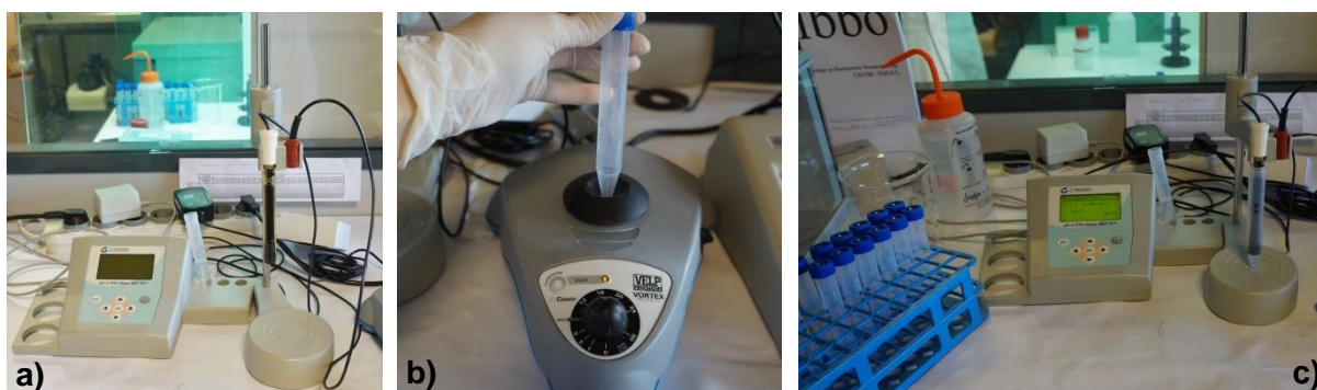
Figura 2: a) Potenciômetro GLP 22+ (Crison®, Barcelona, Spain) acoplado a um eletrodo de íon seletivo de flúor DC219-F (Mettler Toledo®, OH, USA). b) Agitação das amostras no Vortex Mixer ZX Classic (VELP Scientifica®, Europe). c) Medição da concentração de flúor (íon F - ) de cada amostra recorrendo ao equipamento da figura 2a).
