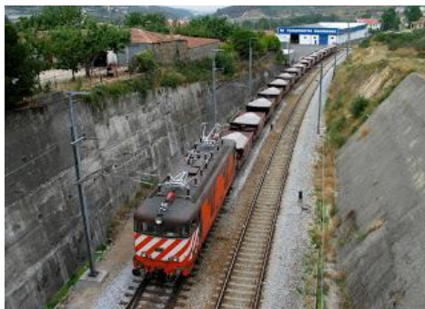
Figura 15 - Comboio de balastro
