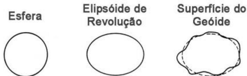
**Figura 3.2- Exemplos das diversas Superfícies Equipotenciais utilizadas ao longo dos anos (Adaptado de Figueiredo, 2001).**
