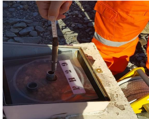
Figura 7: a) Inserção da sonda LNEC no piezómetro hidráulico. b) Inserção da sonda piezométrica no piezómetro hidráulico 29.
