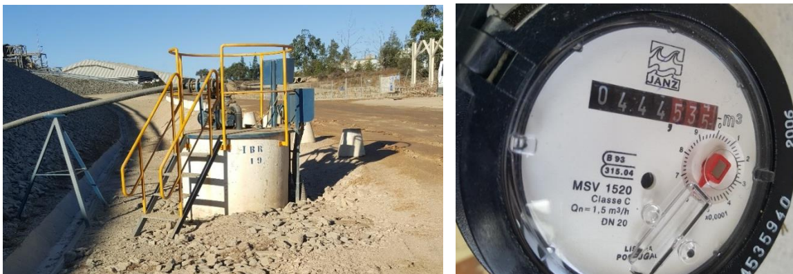
Figura 9: a) Exemplo de um poço, o IBR19. b) Caudalímetro utilizado nas medições do caudal bombeado.
