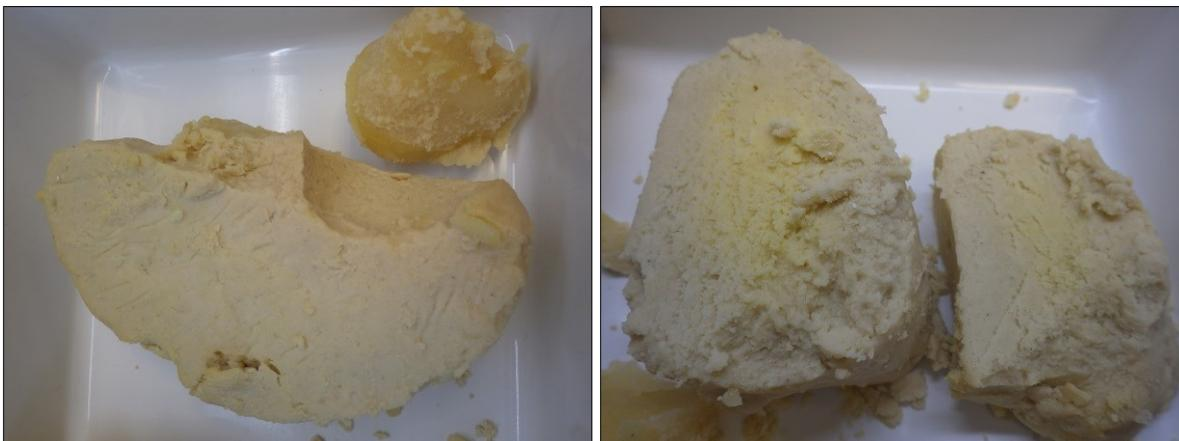
Fig. 20 – L'intérieur du Fantôme II neuf mois après la fabrication. Il est possible de vérifier une altération de la couleur sur les couches les plus extérieures.
