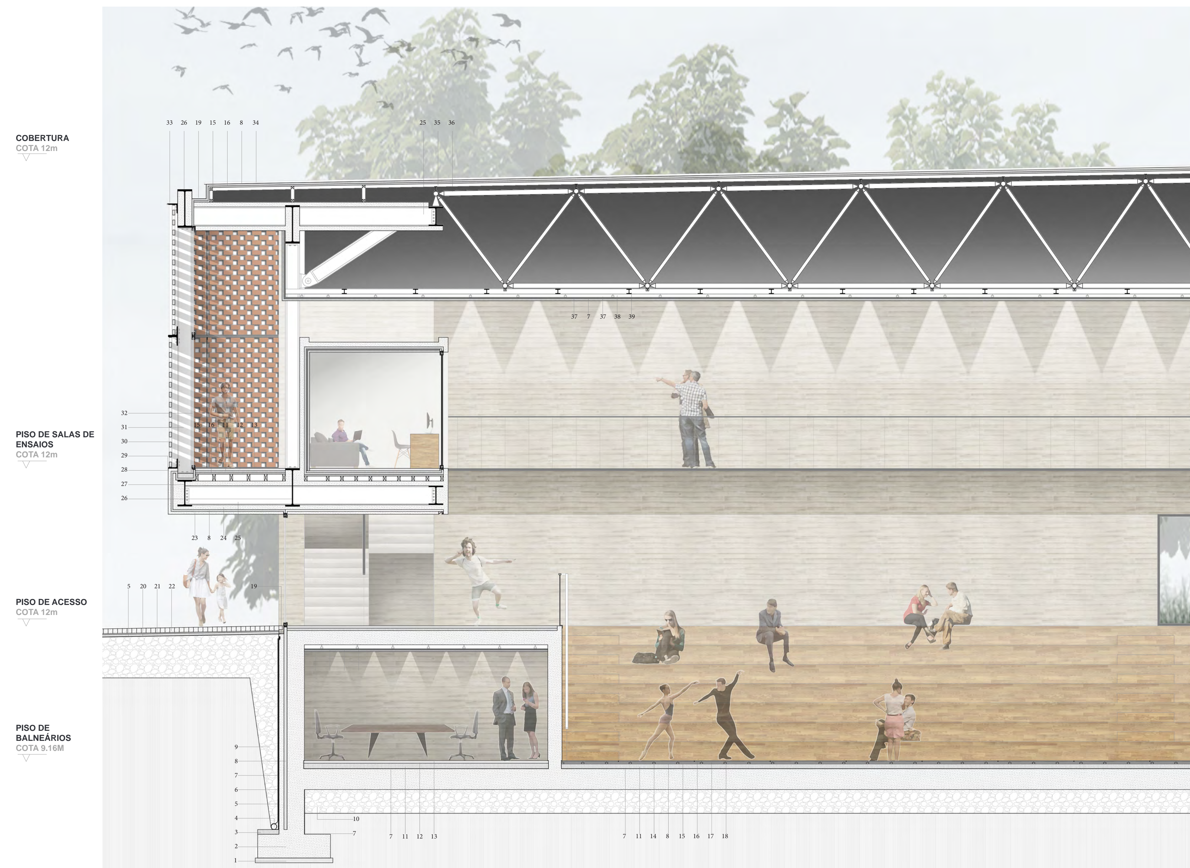
PORMENOR CONSTRUTIVO DA FACHADA 1:50
