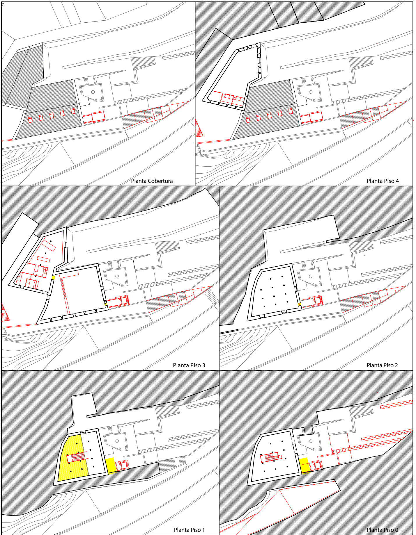
Figura 81- Armazéns da Calheta demolições (amarelo) e construções (vermelho)
