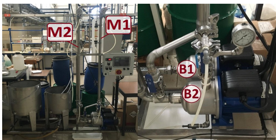
Figura 5.2 – Instalação piloto do processo de UF (B1-alimentação, B2-recirculação, M2-membrana MWCO: 150 kDa e M1- membrana MWCO: 50 kDa).
