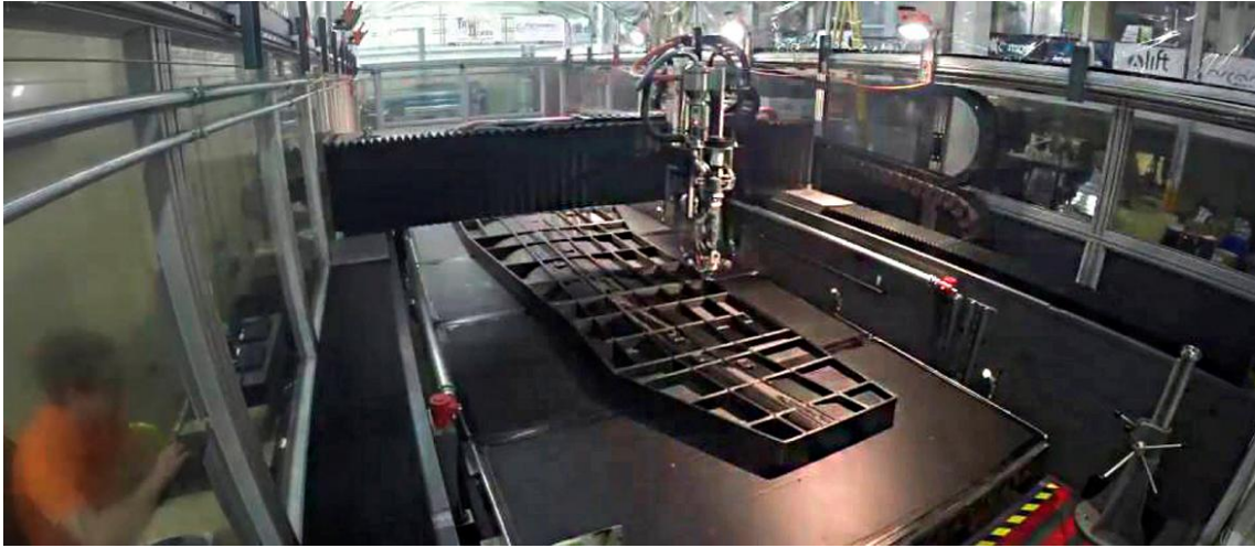
Fig.1: Asa de um Boeing 777X a ser impressa pela Oak Ridge National Laboratory.
