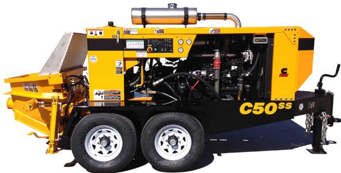
Fig.37: Bomba de betão C50SS.
