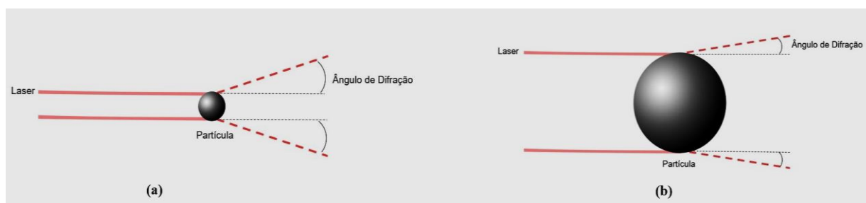
Figura 9 - Difração laser em (a) partículas menores e (b) partículas maiores.
