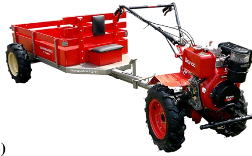
Figura 2 – Exemplo de motocultivadores. a) Motocultivador com charrua atrelada; b) Motocultivador com reboque atrelado 13,14 .
