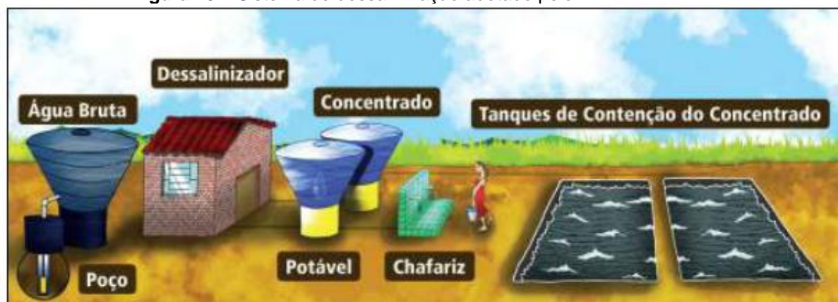
Figura 10 – Sistema de dessalinização adotado pelo PAD.
