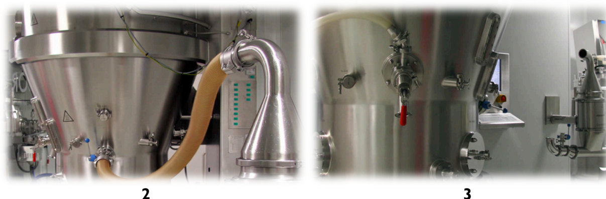
Figura 2 e 3 – Estufa DIOSNA® de duas perspetivas. Além da utilização para a secagem do granulado, também é utilizada para o revestimento de pellets . Adaptado de (1).
