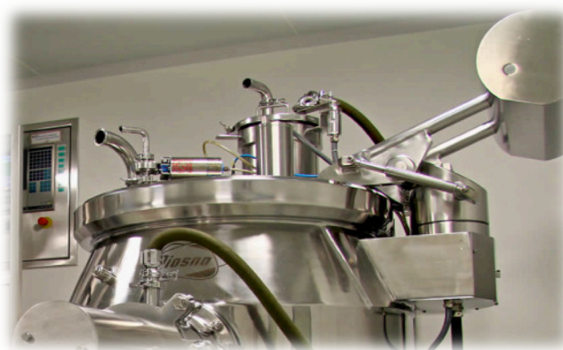
Figura 1 – Granulador DIOSNA®. Adaptado de (1).
