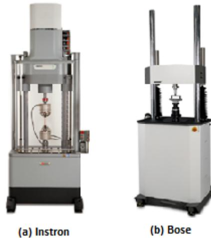
Figura 2.6: Soluções comerciais de máquinas de fadiga acionadas por motores lineares, a) solução comercial disponibilizada pelo site comercial da INSTRON e, b) disponibilizada pela BOSE.
