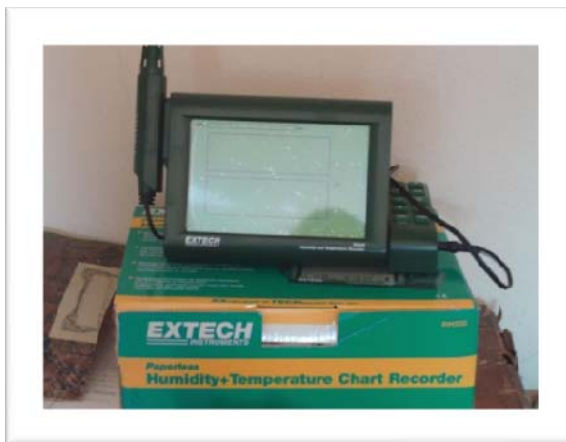
Fig. 6 – Termohigrómetro utilizado na leitura da T e da HR
