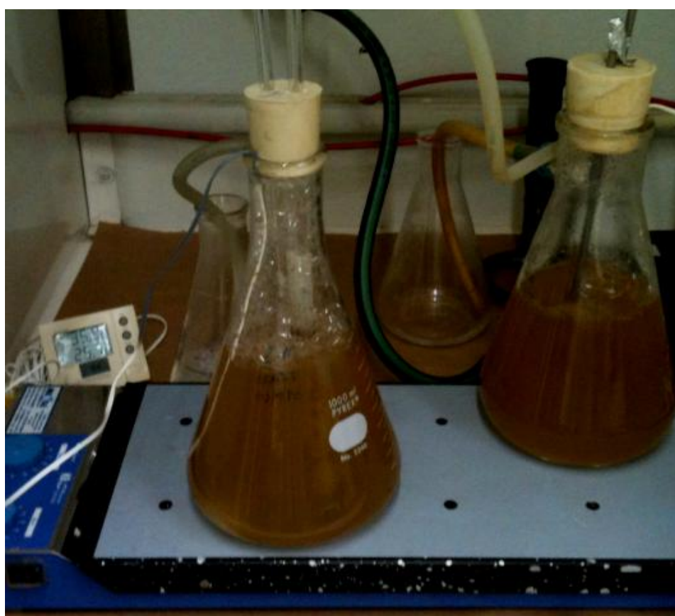
Figura 4.11: Sistema adaptado para fermentação em volume de 800 mL.
