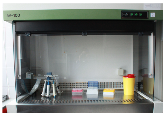
Fig. 14 - Câmara de fluxo laminar, na sala pré-PCR para amostras seguras
