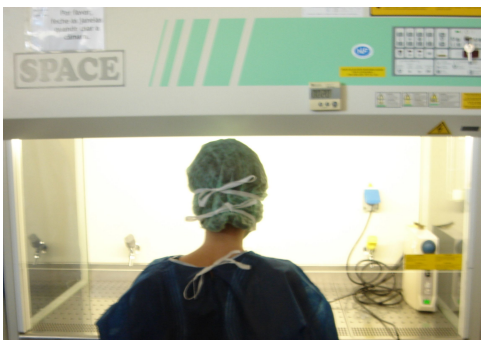
Fig. 8 – Preparação das amostras numa câmara de fluxo laminar
