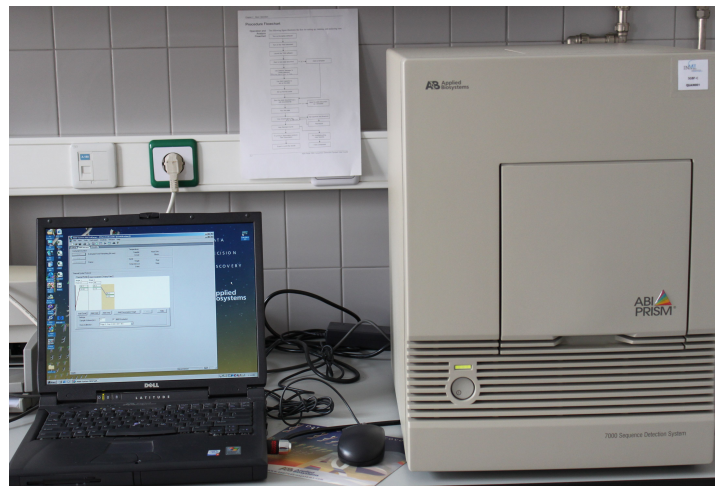
Fig. 13 – Imagem do ABI PRISM 7000, para a quantificação por PCR em tempo real
