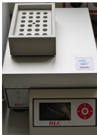
Fig. 10 – Banho em termo-agitação durante 10 minutos a 900 rpm (HLC Biotech®)
