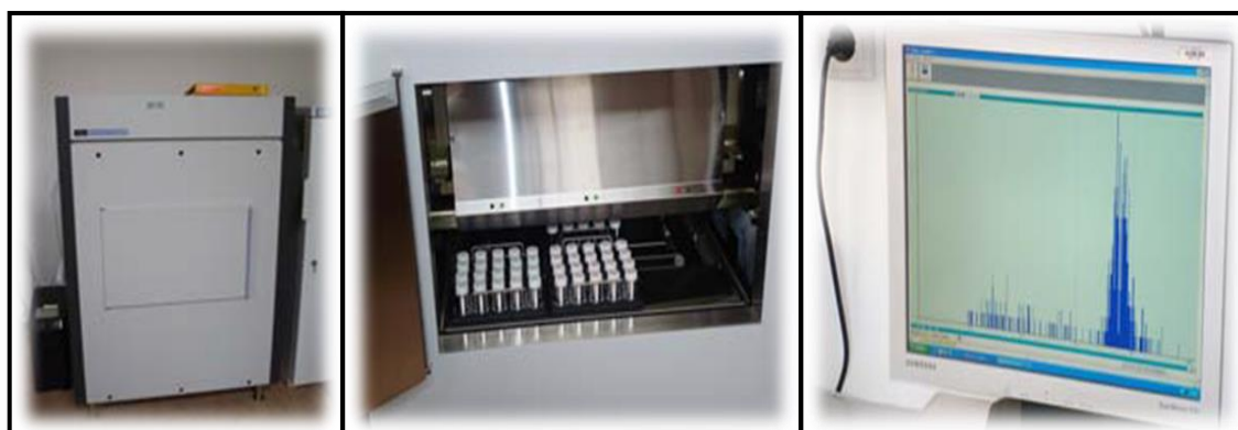
Figura V.25 - Determinação das concentrações de radioisótopos por espectrometria de cintilação líquida Quantulus 1220.
