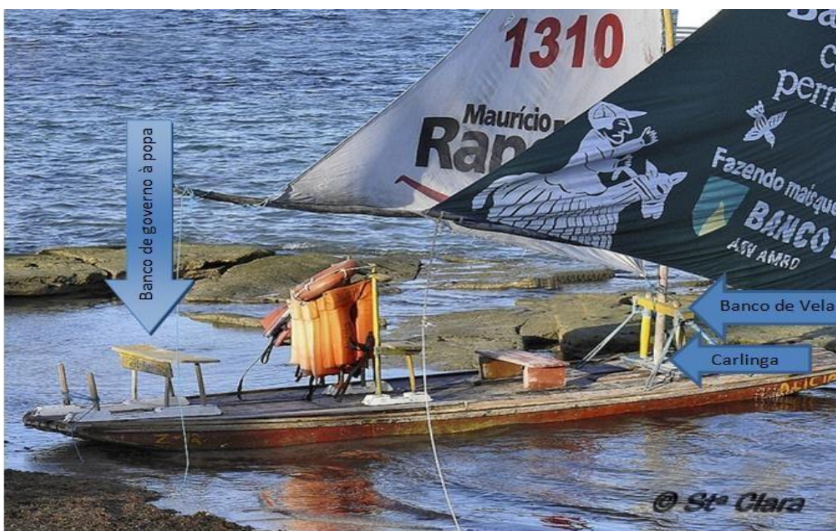
Figura V.5.3.5: Jangada mostrando o banco de governo à popa, o banco de vela e a Carlinga Fonte: Construído pela autora, com base em Sta. Clara (2015).
