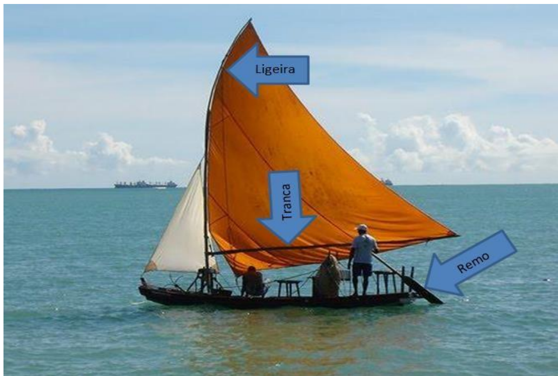
Figura V.5.3.4: A jangada mostrando o macho e a fêmea, o remo, a tranca e a ligeira com os “jangadeiros” Fonte: Imagem com acréscimos da autora com base em A jangada e os “jangadeiros”... Brasil (2010).
