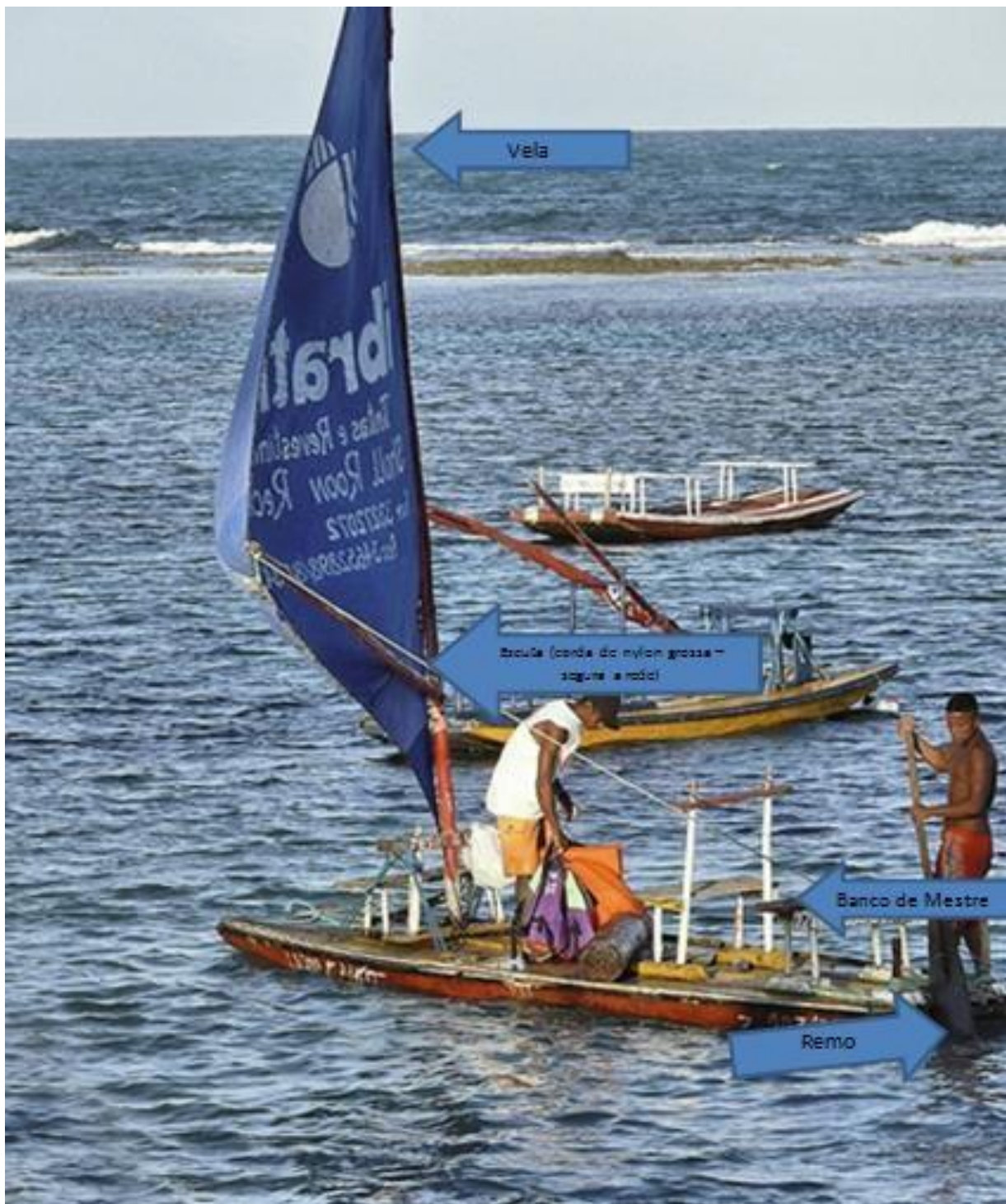
Figura V.5.3.6: Jangada mostrando a escuta que é uma corda de nylon grossa que segura à rede, o banco de mestre e o local do remo em atividade. Fonte: Imagem com acréscimos da autora, com base em Sta. Clara (2015).
