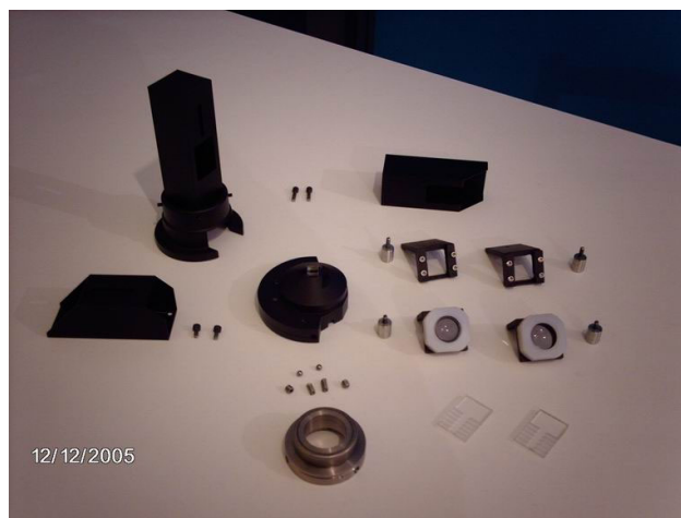
Figura 3.44: Componentes de um adaptador para o HRA clássico (os adaptadores para o HRA modelo 2 são em tudo semelhantes excepto no sistema de fixação ao porto óptico).
