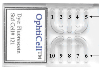
Figura 3.42: Aspecto do modelo de uma das múltiplas versões de células de calibração utilizadas ao longo do processo de desenvolvimento. Os compartimentos 1 a 5 contêm soluções que simulam o soro e os compartimentos 6 a 10 contêm soluções que simulam o vítreo.
