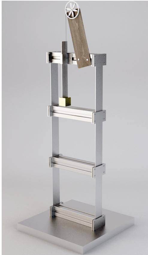
Figura 6.17: Modello 3DOF munito di STMD
