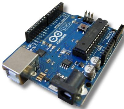
Figura 5.18: Piattaforma hardware Arduino
