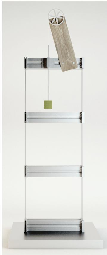
Figura 5.16: Modello 3DOF munito di TMD
