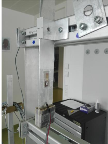
Figura 5.22: Strain gauge per la registrazioni delle accelerazioni del dispositivo TMD
