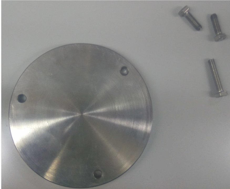
Figura 3.4. Detalle de la terminación rígida del final del tubo en montaje experimental
