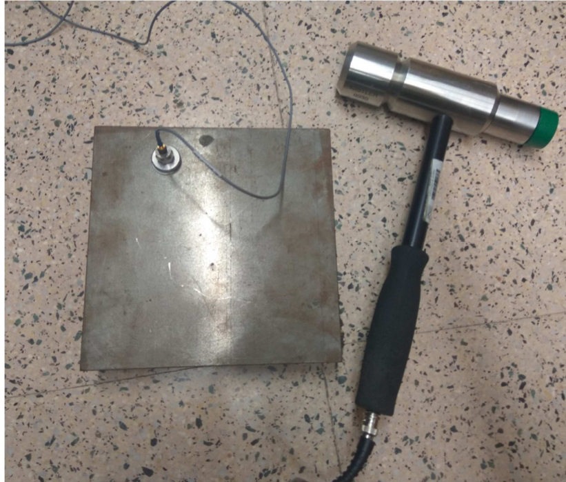
Figura 3.13. Montaje experimental para obtener la rigidez dinámica de un material
