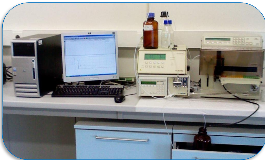
Figura 21 Sistema de HPLC utilizado neste estudo para a quantificação de monoaminas (Fotografia tirada no Laboratório de Farmacologia e Terapêutica Experimental da Faculdade de Medicina da Universidade de Coimbra).
