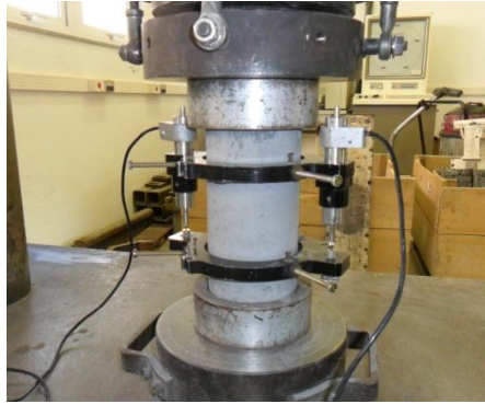
Figura 4.10 – Ensaio de módulo estático de elasticidade
