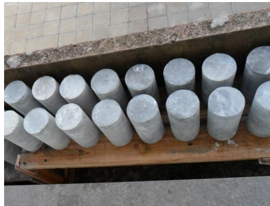
Figura 4.3 – Acondicionamento dos corpos de prova no ambiente exterior
