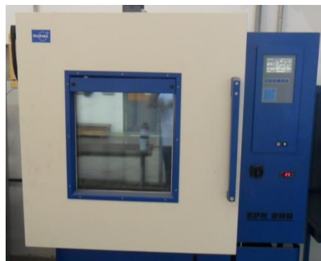
Figura 4.7 – Reidratação dos corpos de prova em câmara climatizada
