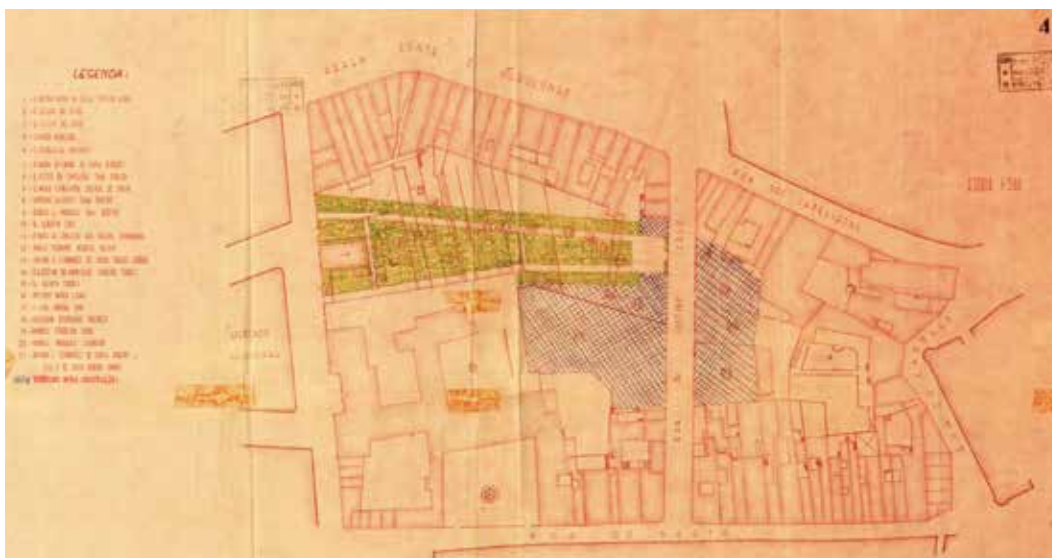
08. Anteplano de Urbanização de Braga - Planta de Arranjo parcial. Demolição dos anexos no interior do quarteirão e desenho de um pequeno parque linear | Etienne de Gröer | 1944.
