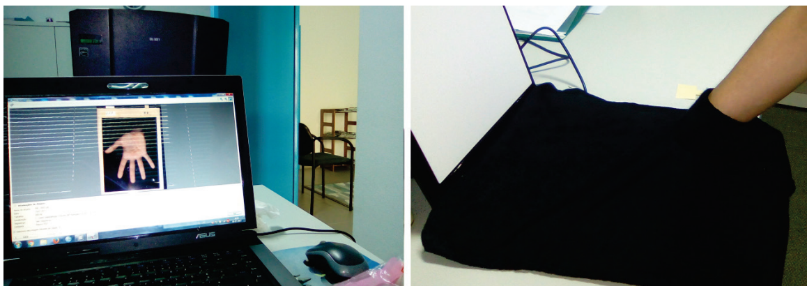
Figura 5: Procedimento de medição: um dos gabinetes utilizados para a recolha da amostra e manga de tecido para evitar a sobre-exposição.
