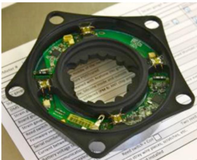
**Figura 3 – Extensômetros**
