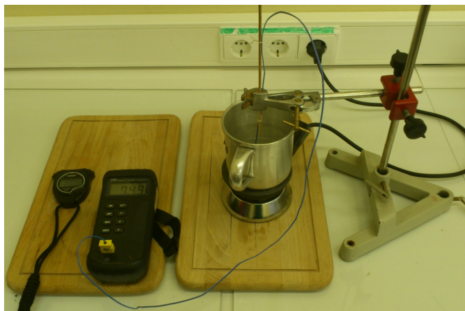
Figura 13.2: Esquema da experiência de arrefecimento para obter a constante de arrefecimento de Newton.
