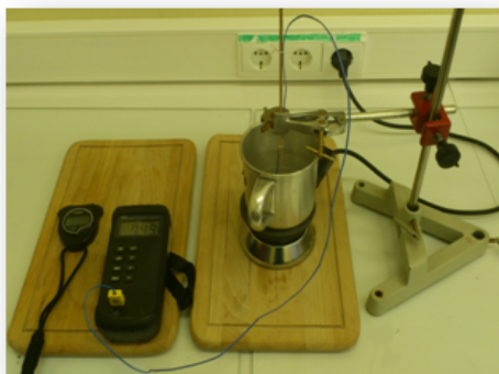
Figura 5.31: Material usado na atividade experimental “ Calor latente de evaporação da água ”.
