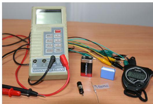
Figura 1: Material para a “Construção de um relógio logarítmico”: um voltímetro, uma pilha de 9 V, fios elétricos, um interruptor, um cronómetro, um condensador de 10 \mu\text{F} e uma resistência de \sim 10 \text{M}\Omega .
