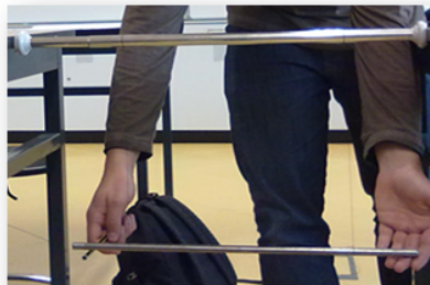
Figura 5.28: Material usado na atividade experimental “ Pêndulo Bifilar ”. Fonte: Imagem da autoria de João Correia, fevereiro de 2014.
