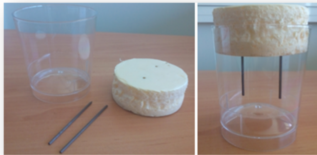
Figura 6.7: Construção de um voltâmetro com materiais simples, de fácil acesso e de baixo custo.
