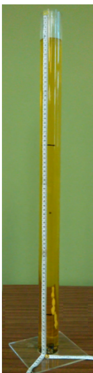
Figura 2: Esfera em movimento no interior de um fluido viscoso.
