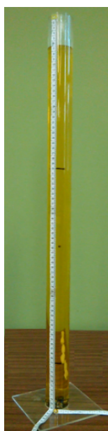
Figura 1: Esfera em movimento no interior de um fluido viscoso.
